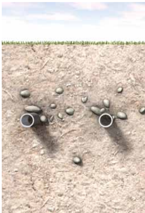
Installation RAUGEO collect en PE-Xa
